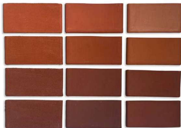
Ricerca materica su elementi in stoneware, cotti a temperature diverse (980°C 1120°C 1220°C 1250°C) per lo studio delle possibili soluzioni cromatiche di prospetto e di copertura.
