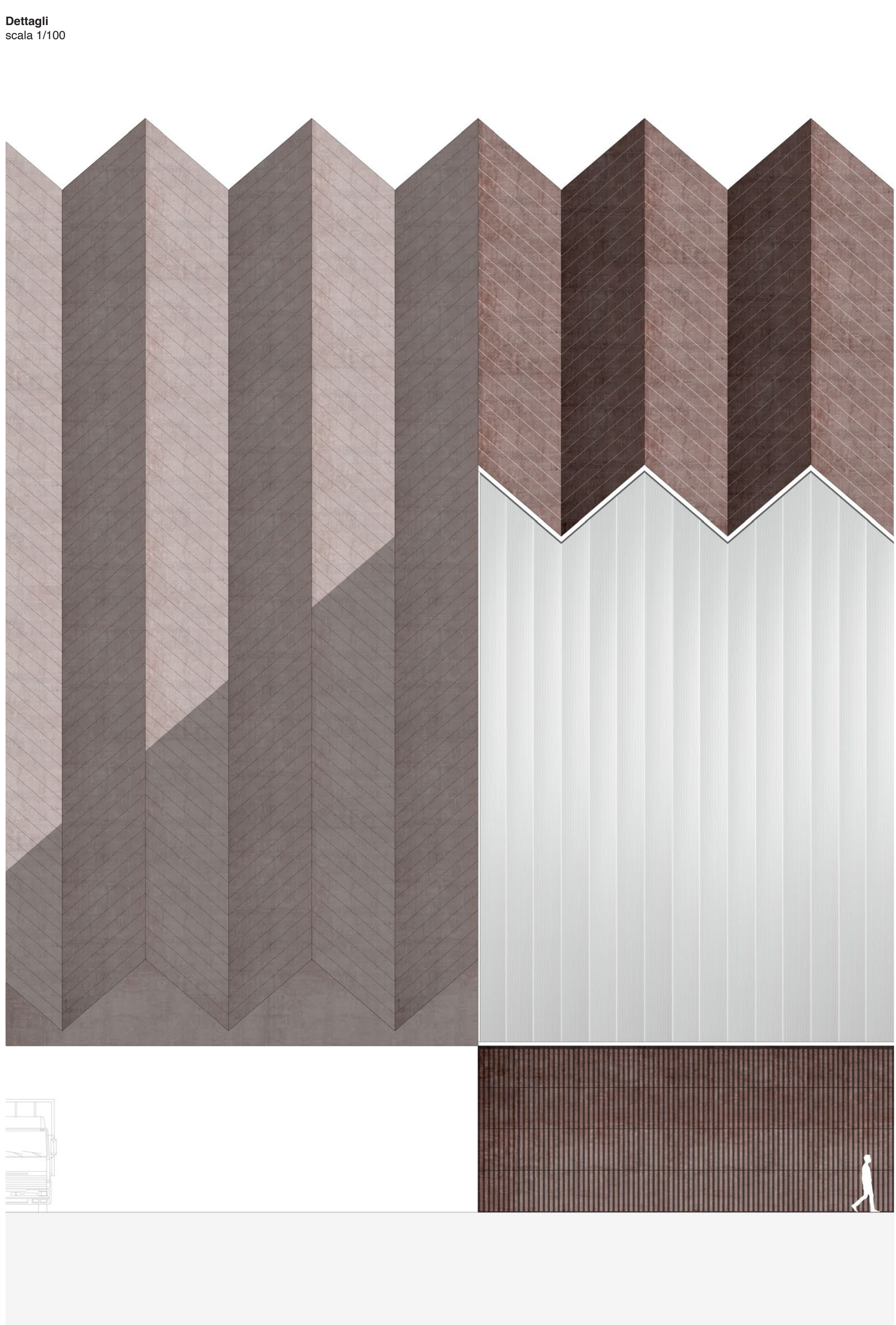
Dettaglio di prospetto. In evidenza la volontà di utilizzare materiali e crome che riconducono ai colori della terra. Il basamento in pannelli prefabbricati in cemento, la copertura in lastre di alluminio riciclato e le facciate continue in policarbonato di reminiscenza industriale.
