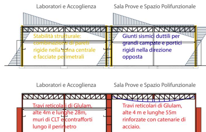
Diagrammi di carico strutturali - Senza scala
