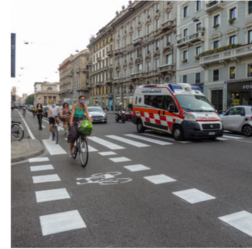
attraversamento ciclabile (pista ciclabile in corsia riservata tracciata in carreggiata) intersezione non semaforizzata
