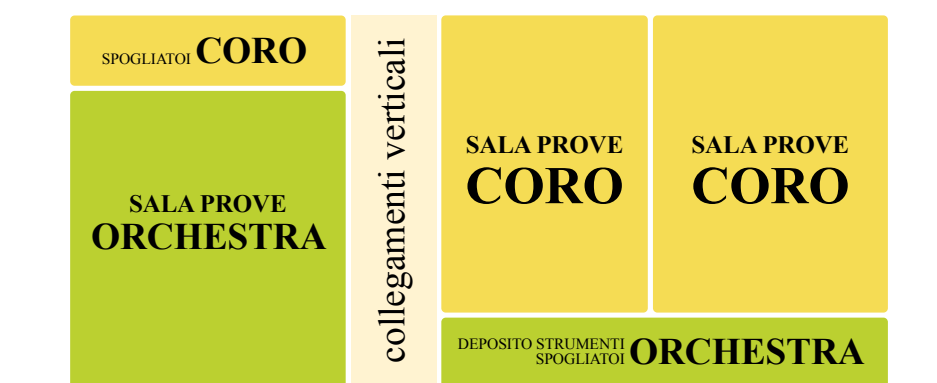
fig. 26 Schema funzionale in sezione delle sale prove e dei relativi servizi.
